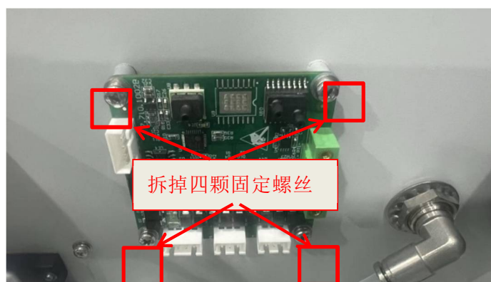
图 9.24 1002B 固定螺丝位置图
