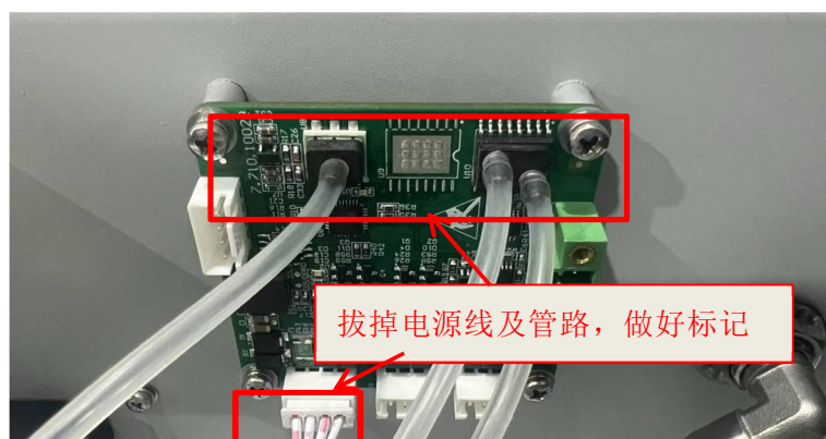
图 9.23 1002B 电路板图
