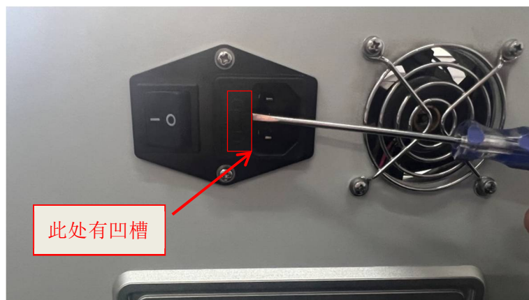
图 9.14 电源滤波器凹槽位置图
