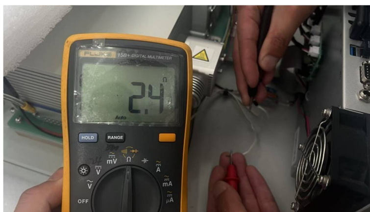
图 9.10 光源电阻测试图
